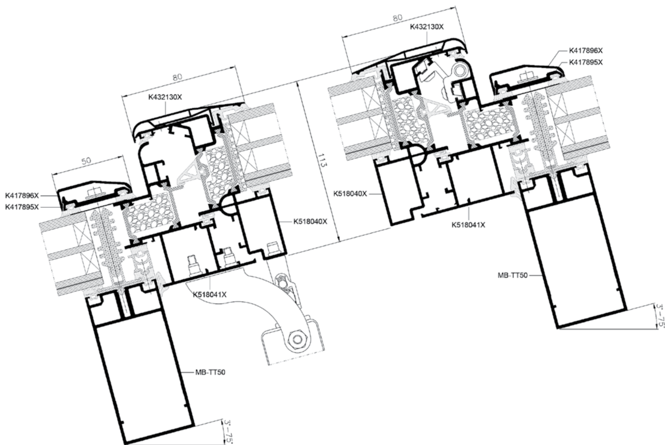
Dwarsdoorsnede door rookverwijderend raam MB-RW in glazen dak van het systeem MB-TT50
